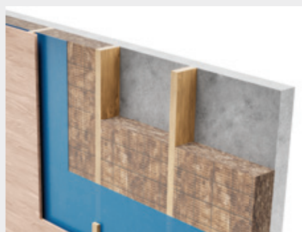
Traditioneel bevestigingssysteem met isolatie tussen houten regelwerk
